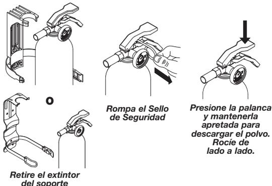
1. Retire el extintor del soporte de montaje.
